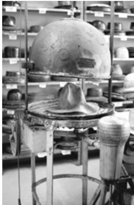
Unter einer Dampfglocke werden die feuchten Filzstumpen gedämpft, dadurch werden sie dehn- und formbar.
